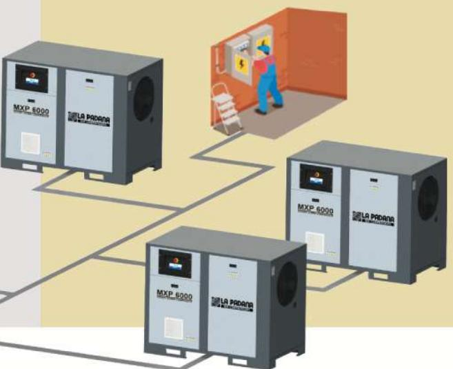
I controllori L9 e L19 comunicano internamente con il compressore grazie a moduli di ingresso/uscita appositamente progettati per esigenze specifiche delle diverse gamme di compressori.
